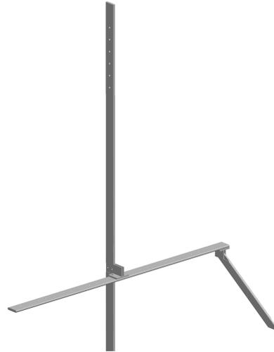
FIG. 5.5 – Support de sonde pour mesures en envergure.
